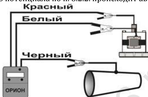
Рисунок 7 – Схема подключения ОРИОН ИП-01
