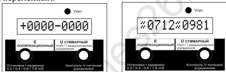
Рисунок 7.3 – Индикация значений потенциалов
