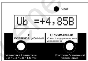
Рисунок 7.2 – Индикация напряжения питания
