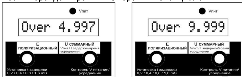
Рисунок 7.7 – Индикация порога перегрузки
