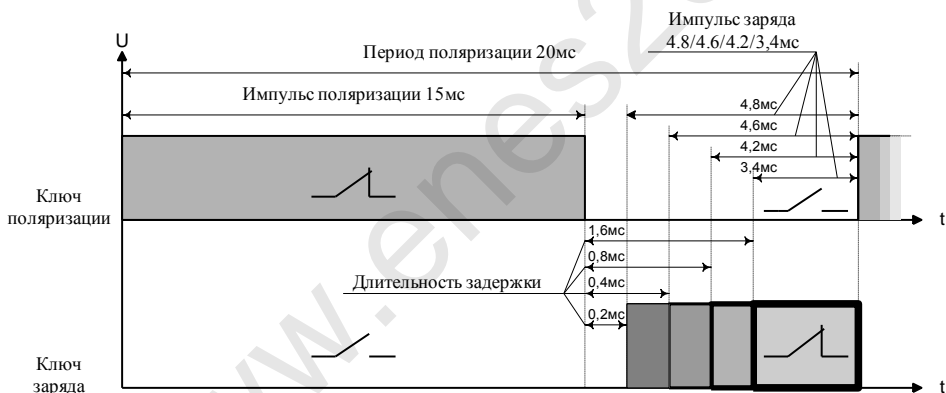
Рисунок 4.3 – Временные диаграммы управления ключами заряда и поляризации
