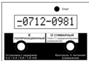
Рисунок 7.9 – Индикация режима экстраполяции потенциалов
