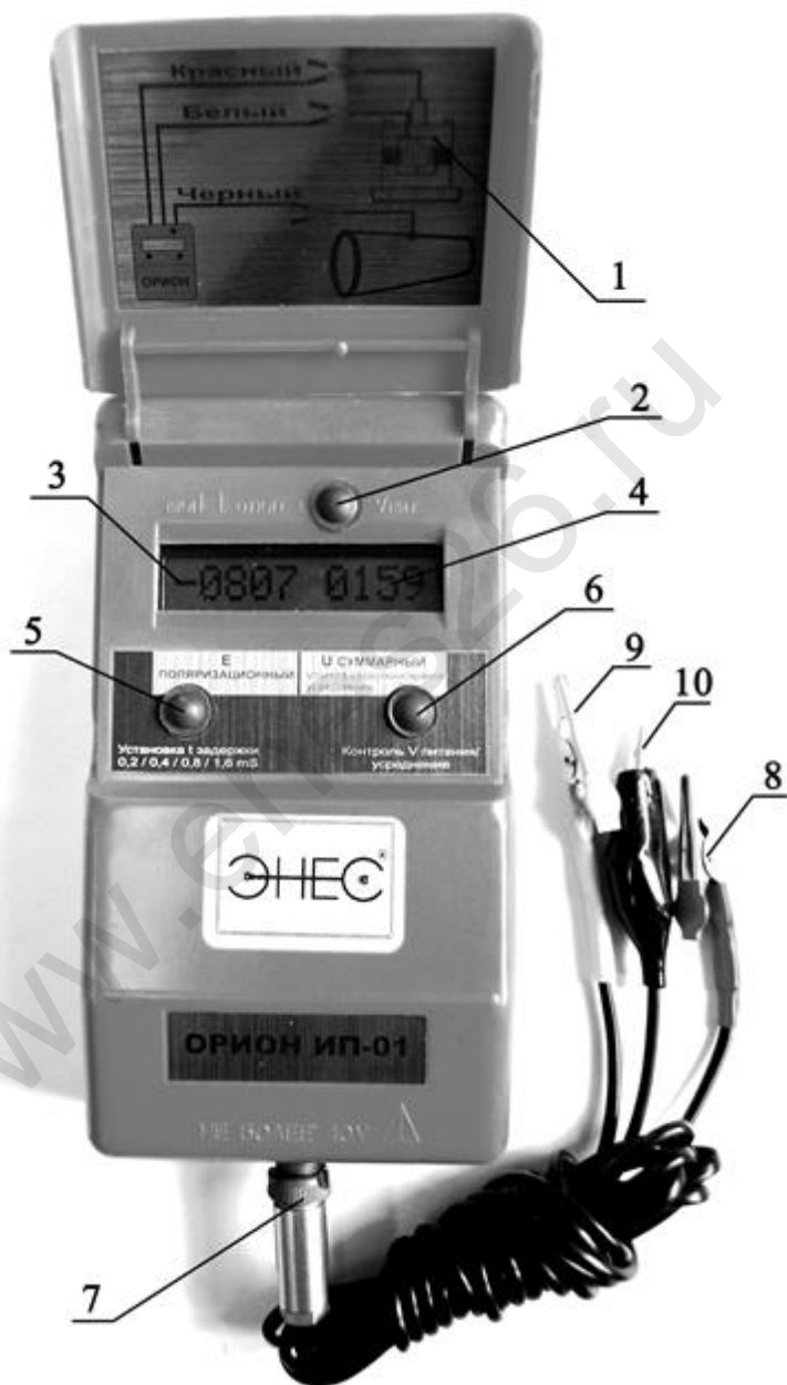
Рисунок 7.1 – Расположение органов управления, индикации и подключения
