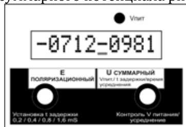
Рисунок 7.6 – Индикация усредненных значений потенциалов
